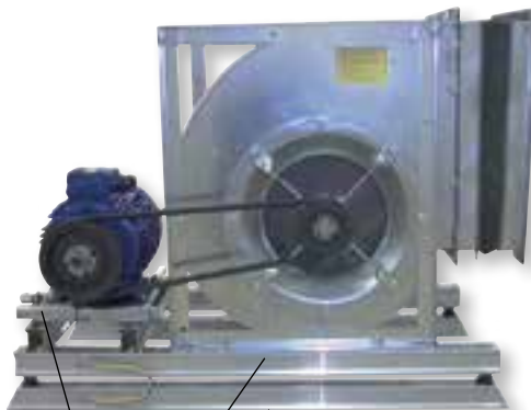
Салазки, обеспечивающие натяжение ремня
